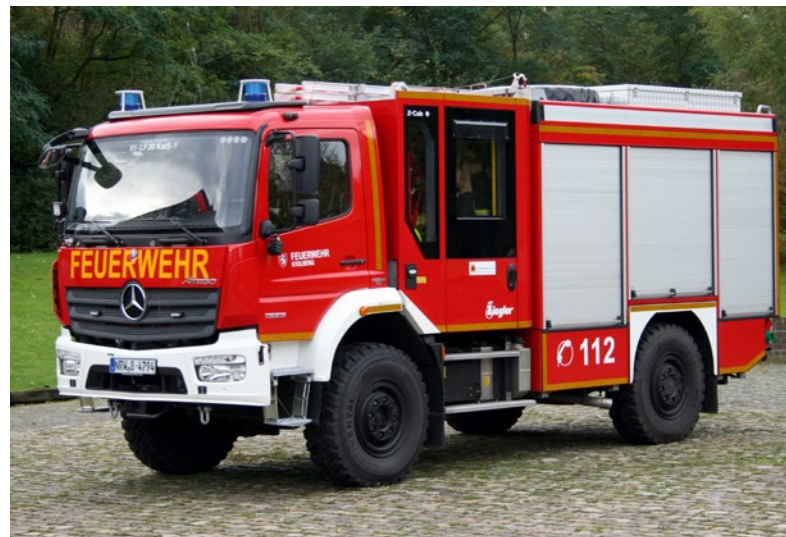
Abb. 28: Beispiel eines geländegängigen Einsatzfahrzeugs vom Typ „Löschgruppenfahrzeug für den Katastrophenschutz“ (LF 20 KatS). (Quelle: Wolfgang Tribbels / CM-Foto)
