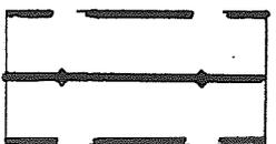
Hochspannungsfreileitung 20-kV ÜWU mit beiderseits 12,0 m Ausübungsbereich. Sofern die Leitung nicht verkabelt wird dürfen Bauwerke im Leitungsausübungsbereich nur mit Zustimmung der ÜWU AG errichtet werden. Detaillierte Baupläne sind vorzulegen.
